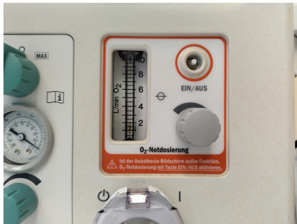
(a) O 2 -Notdosierung
