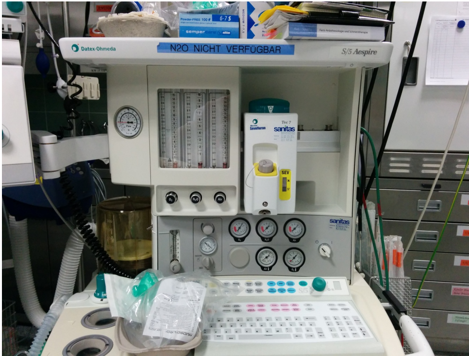
Fig. 18: Narkosemaschine mit pneumatischer Frischgasdosierung und Rotameter
