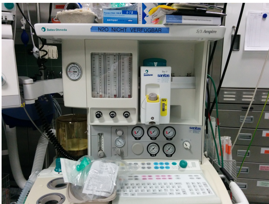
Fig. 18: Narkosemaschine mit pneumatischer Frischgasdosierung und Rotameter
