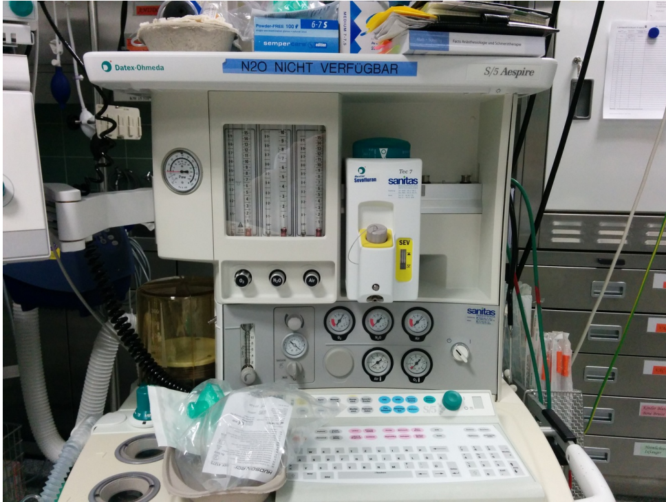
Fig. 18: Narkosemaschine mit pneumatischer Frischgasdosierung und Rotameter
