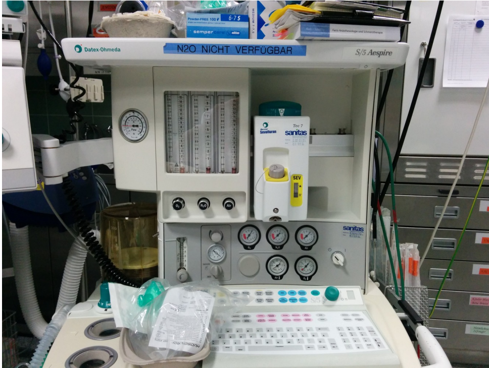
Fig. 18: Narkosemaschine mit pneumatischer Frischgasdosierung und Rotameter
