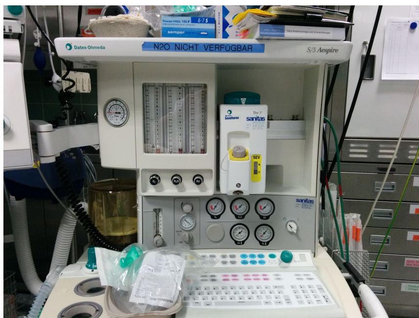
Fig. 18: Narkosemaschine mit pneumatischer Frischgasdosierung und Rotameter
