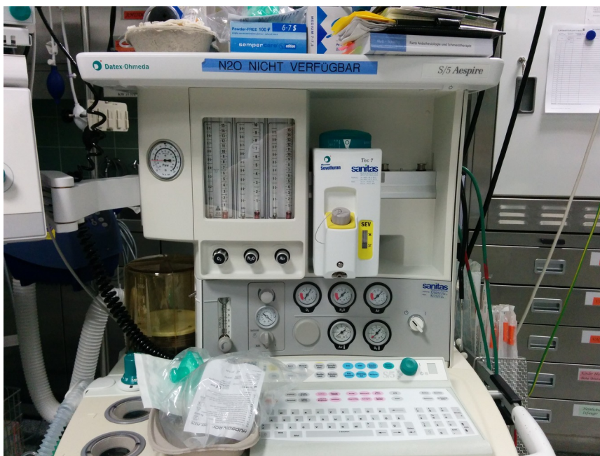
Fig. 18: Narkosemaschine mit pneumatischer Frischgasdosierung und Rotameter
